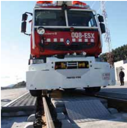
• Camió amb dispositiu per circular per les vies del TGV
