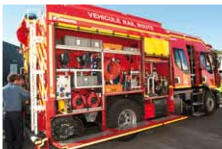
• Camió de bombers expressament equipat per circular per les vies del TGV (Arxiu Josep Ribas)
